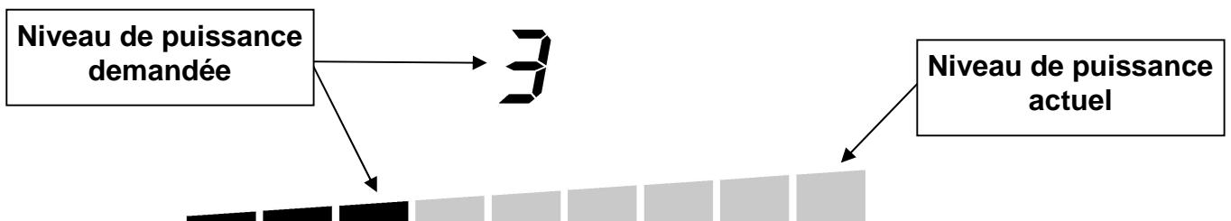
Les segments de l'affichage du niveau de puissance s'éteignent un par un jusqu'au niveau de puissance demandé.
