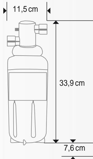
Beim Wechsel werden 7,6 cm Mindestabstand vom unteren Rand der Patrone bis zum Boden benötigt!
